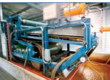
Slibverwerking met zeefbandpers
