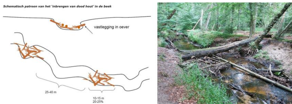
Figuur 40: Schema en voorbeeld aanbrengen dood hout. Bron: Waterecologie.nl.
