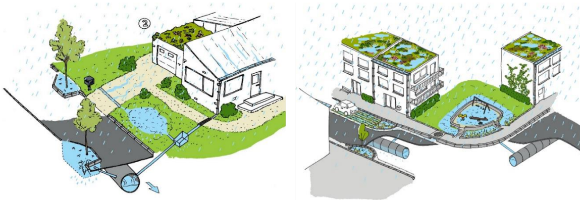
Figuur 6. Opvang en vertraagd afvoeren van hemelwater bij een norm neerslag © Aquafin.
