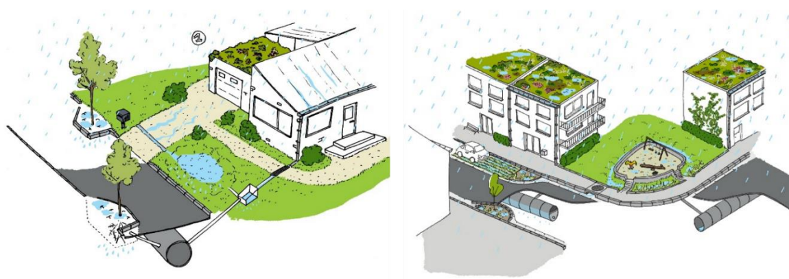
Figuur 5. Opvang en infiltratie van hemelwater bij frequente neerslag © Aquafin.
