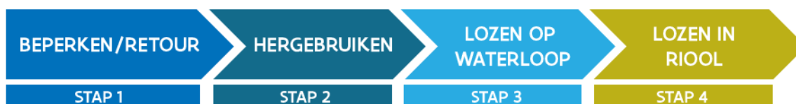
Figuur 9. Richtlijnen met de te doorlopen stappen bij bemaling van grondwater. © VMM
