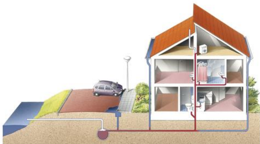
Figuur 1: Een gemengd stelsel: hemelwater en afvalwater worden via eenzelfde riool afgevoerd naar de waterzuivering.
