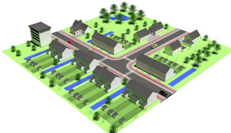
Figuur 73: Bij bestaande woonprojecten (waar meestal geen hergebruik is) kan de zone tussen 2 woonblokken als infiltratiebuffer aangesneden worden. Er komt dan één afvoer voor alle aaneengesloten woningen. De bufferlocaties krijgen bij voorkeur ook een vorm van hergebruik. In een nieuwe verkaveling kan de regentuin/infiltratiebuffer gemeenschappelijk aangelegd worden. In bovenstaand voorbeeld wordt de overloop van de hemelwaterput naar een gemeenschappelijke infiltratiebuffer geleid.
