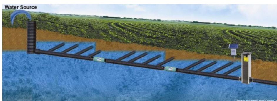
Figuur 46: Principeschets subirrigatie (bron: www.bdb.be )
