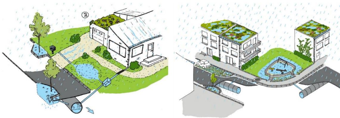
Figuur 29. Opvang en vertraagd afvoeren van hemelwater bij een norm neerslagafvoer © Aquafin.
