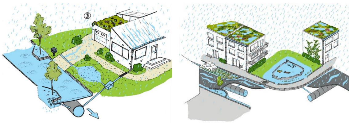
Figuur 30. Extreme neerslagafvoer: gecontroleerd overstroomen © Aquafin.
