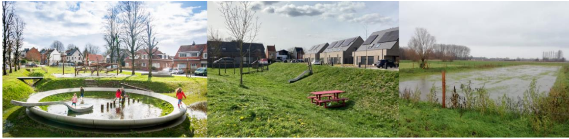
Figuur 33. Bovenlokale buffers kunnen meerdere functies combineren. Links en midden wordt de bufferfunctie gecombineerd met een recreatieve functie, waar de foto rechts infiltratie en buffering combineert. Locatie: (links) Kontich, (midden) Kortrijk en (rechts) Kruisem. © Aquafin
