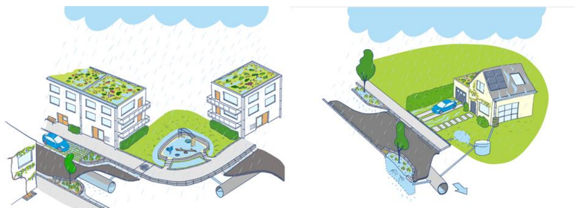
Figuur 13. Opvang en vertraagd afvoeren van hemelwater bij een norm neerslag © Aquafin.
