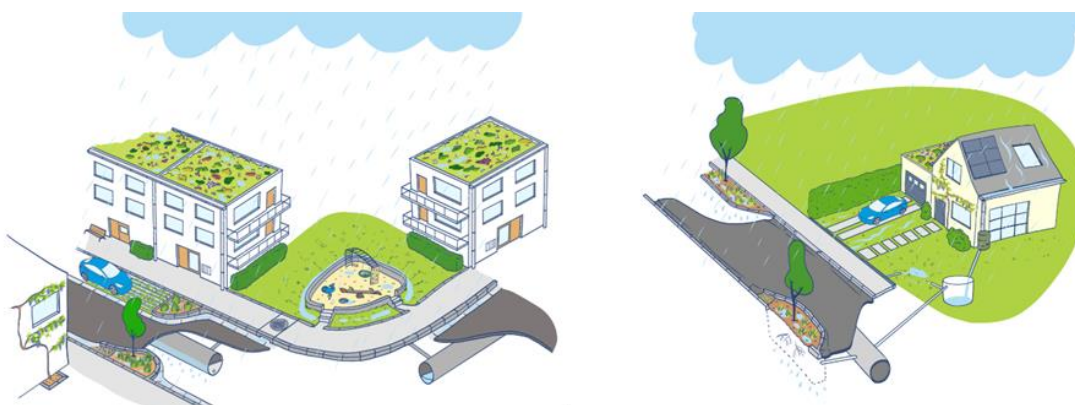
Figuur 12. Opvang en infiltratie van hemelwater bij frequente neerslag © Aquafin.
