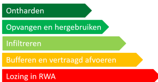
Figuur 2-1 : De brongerichte omgang met hemelwater op basis van de ladder van Lansink (bron: Coördinatiecommissie Integraal Waterbeleid, 2012)
