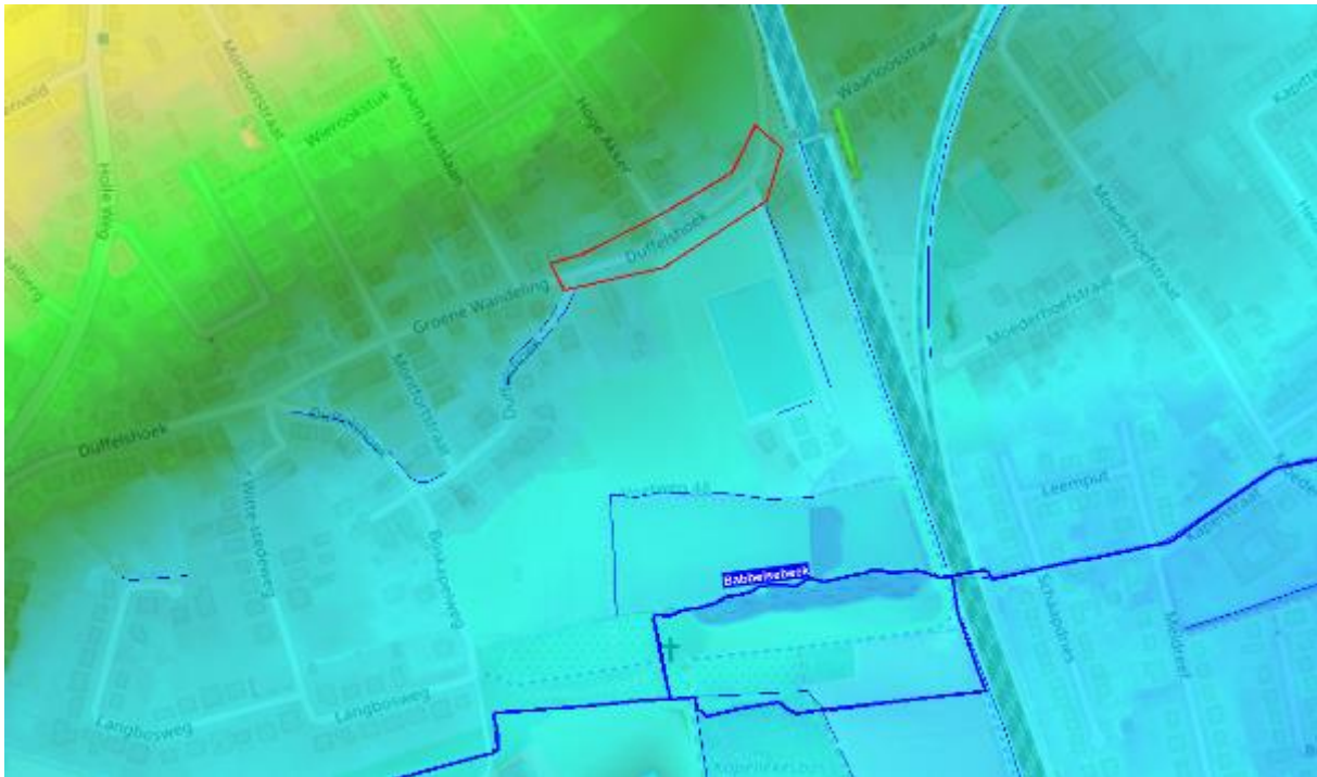
Figuur 19: aanduiding van de probleemzone. Zoals te zien op de reliëfkaart is er geen reden dat het water hier zou blijven staan mits de bovenbouw zou ingericht zijn om het water verder te laten wegstromen richting Babbelsebeek.
