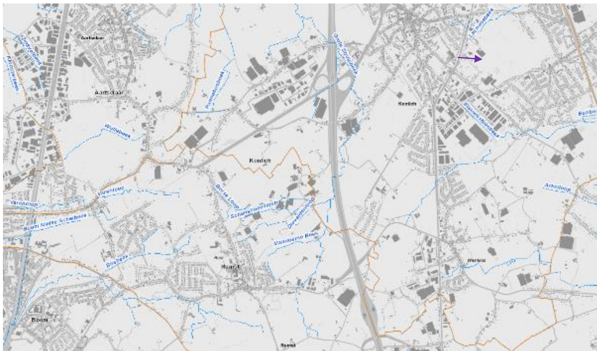
Figuur 4: Overzicht van de het opwaartse stroomgebied van de loop van de Grote Struisbeek. Hier is ook uit op te maken dat er tussen de gemeente grens en de N171 geen enkele officiële waterloop is, behalve de zijtak naast het bedrijf Agora (zie oranje pijl). Deze zijtak is met andere woorden de enige afvoer mogelijkheid voor dit gebied.
