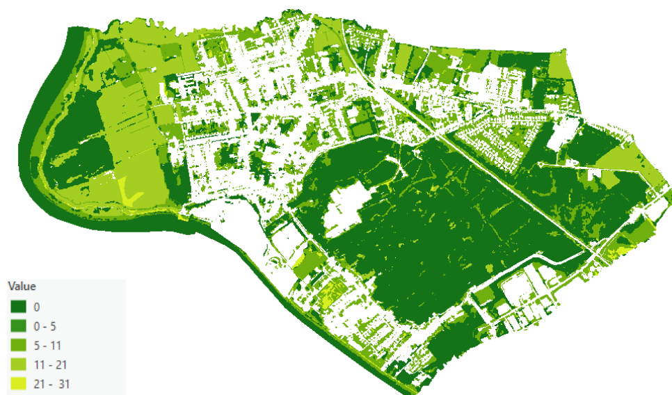
Figuur 2-8 Verschilkaart met afstromingscoëfficiënten. De onverharde oppervlaktes zijn de groene afbakeningen waarbij de verschillen grotendeels 10-20% bedragen. Alle waarde van meer dan 30% worden beschouwd als verharde oppervlaktes en zijn weggelaten.
